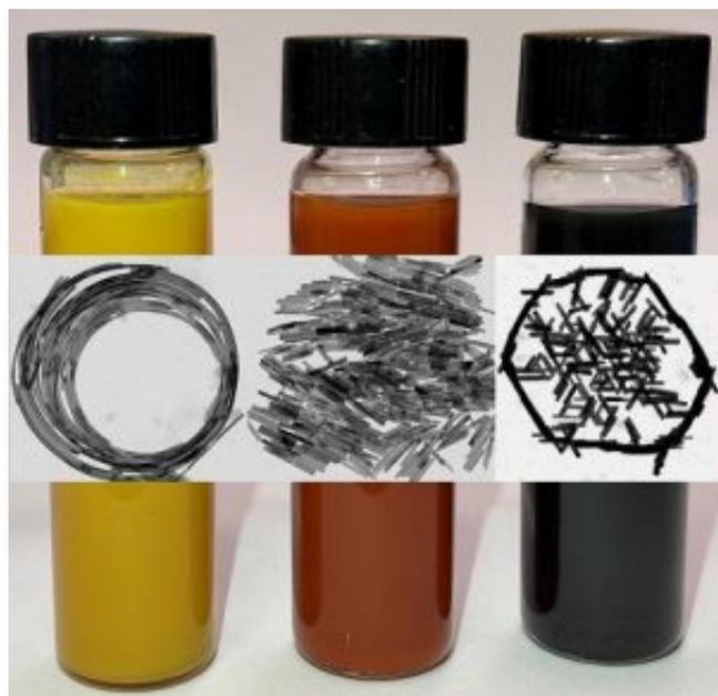
*Dispersioni colloidale di nanocristalli di calcoalogenuri di bismuto*
