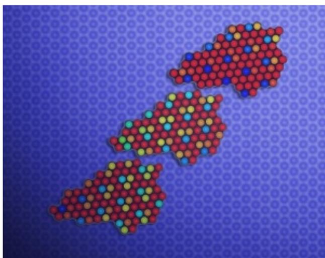
Alcuni fotogrammi dello spostamento di un'isola colloidale su di un substrato microstrutturato. Le particelle sono colorate al computer a seconda della loro posizione rispetto alle buche della superficie microstrutturata (in blu, quando coincidenti)
