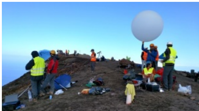
Foto 5 : preparazione al lancio di pallone per studio del campo elettrico sulla vetta del vulcano Stromboli (credits: HPHT lab INGV)
