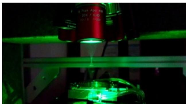
Particolare del sistema laser di fabbricazione dei circuiti in diamante
